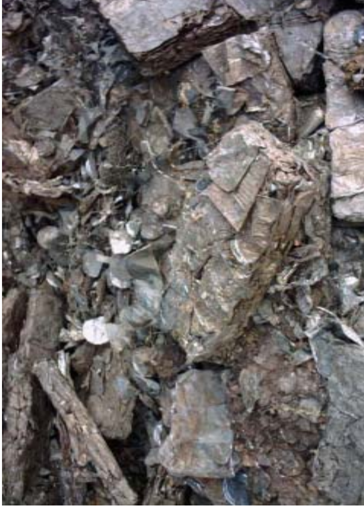
RIPRESA FOTOGRAFICA PRESSO ACCIAIERIA Dettaglio scatolame distagnato in pacchi
